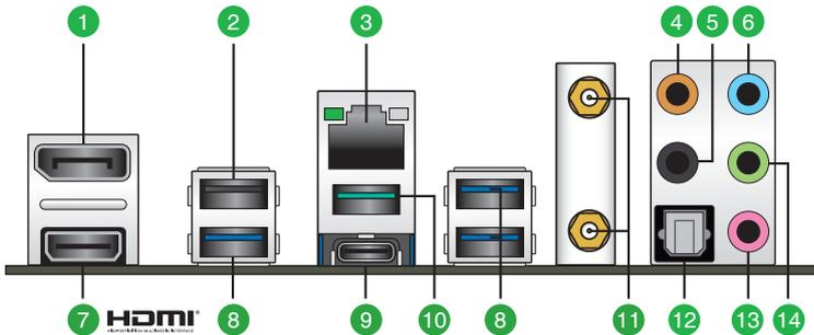
1. **DisplayPort.** Dieser Anschluss ist für DisplayPort-kompatible Geräte.
